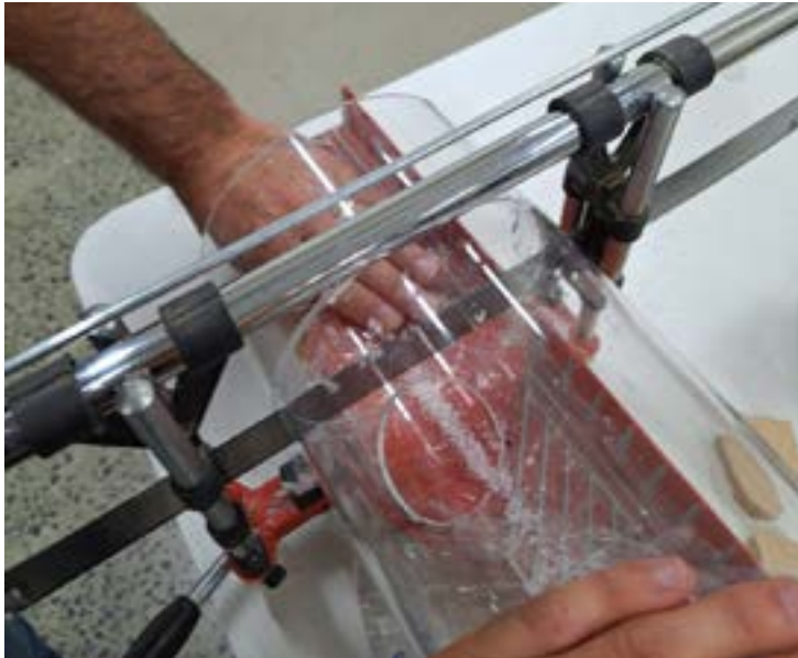
FIGURA 8 — Fixação e corte do tubo de acrílico
