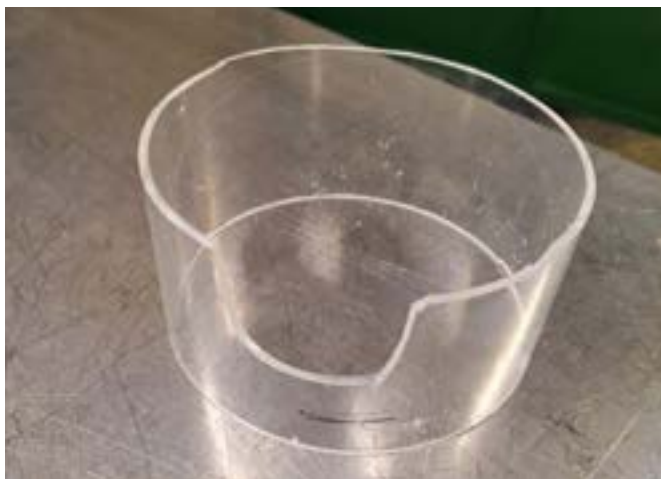
FIGURA 9 — Resultado final da retirada da parte quebrada do tubo acrílico
