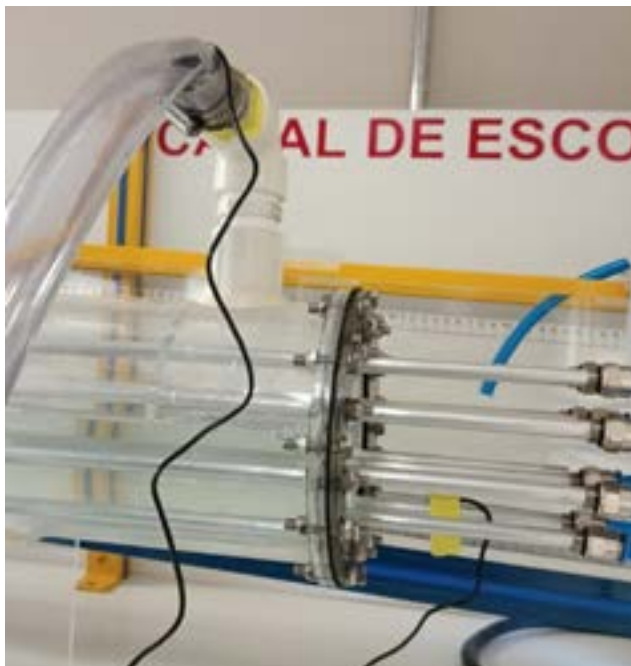
FIGURA 27 — Conexão dos dispositivos no trocador de calor
