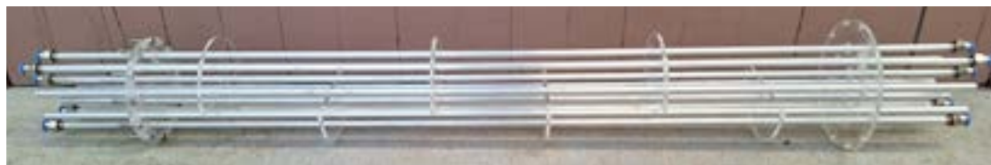
FIGURA 6 — Chicanas encaixadas nos tubos de alumínio
