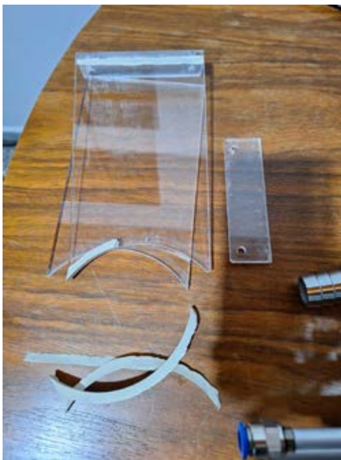
FIGURA 7 — Apoio do trocador de calor
