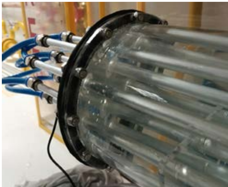
FIGURA 33 — Bolhas de ar na entrada do trocador
