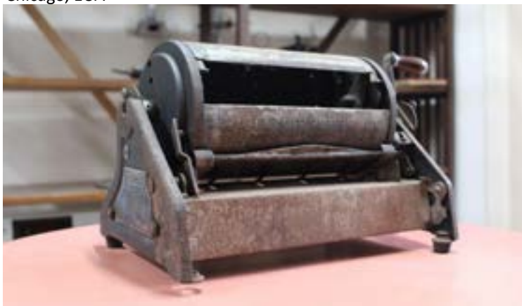
FIGURA 12 — Mimeógrafo Edison Dick, Modelo 30, cerca de 1930, fabricada em Chicago, EUA
