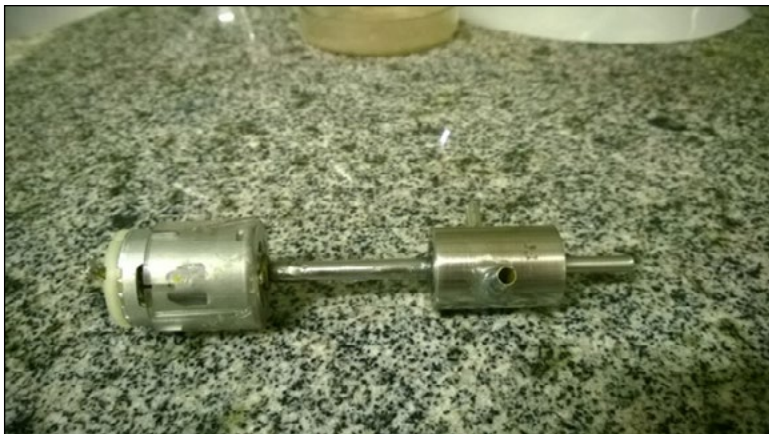
FIGURA 10 – Montagem: turbina e dínamo
